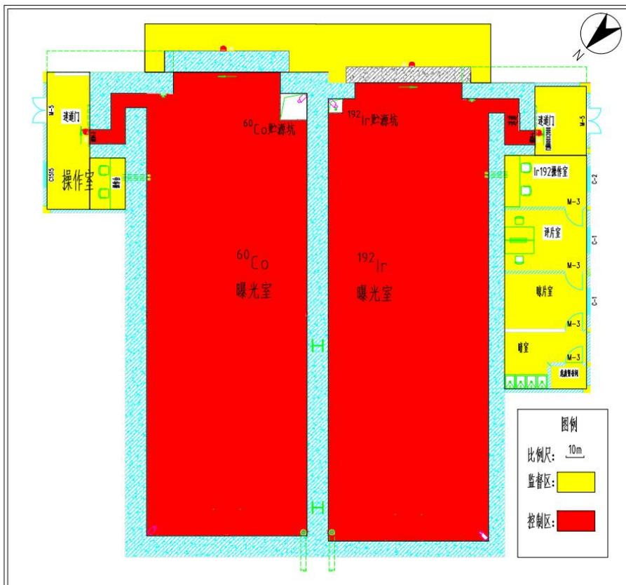
图 10-4  $^{192}\text{Ir}$ 、 $^{60}\text{Co}$ - $\gamma$ 射线探伤室两区划分示意图
