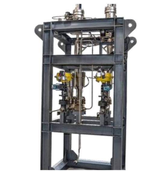
钠水反应试验装置
